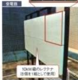
図1 10kW級の高効率レクテナを開発 京都大学生産研究部の電波研究室で、電力伝送実験に成功した(a)。開発したレクテナの出力は1個当たり約1.2kWで、16個の素子を組み合わせている(b)。
